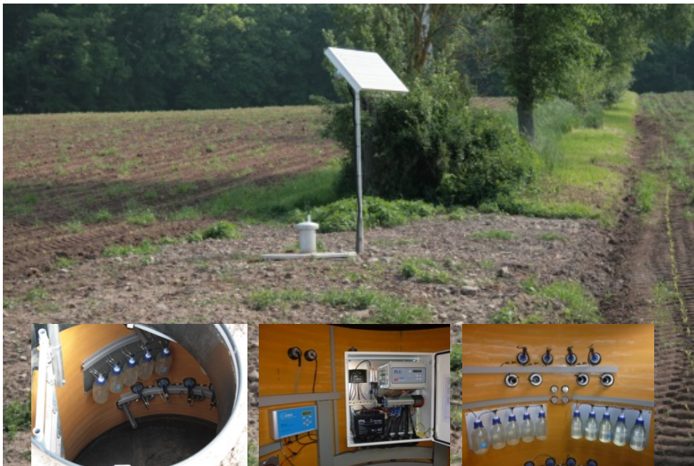
Abbildung 14-3: Standort des Sickerwasserschachtes für das maßnahmenbegleitende Monitoring Sickerwasser in Triesdorf. Beidseitig die Ackerflächen, unter denen Sickerwasserproben mittels Saugkerzen gezogen werden (Bildmitte). Die kleinen Fotos zeigen den Sickerwasserschacht von innen mit Messtechnik und Probenahme.
