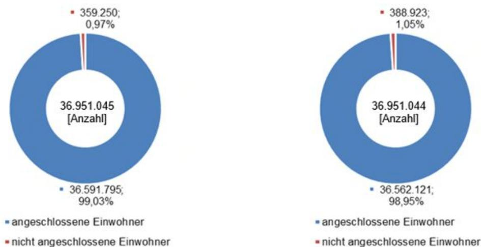
Abbildung 3-19: Anschlussverhältnisse der öffentlichen Kanalisation (links) und Zentralen Kläranlagen (rechts) FGE Rhein (Stand 2016)
