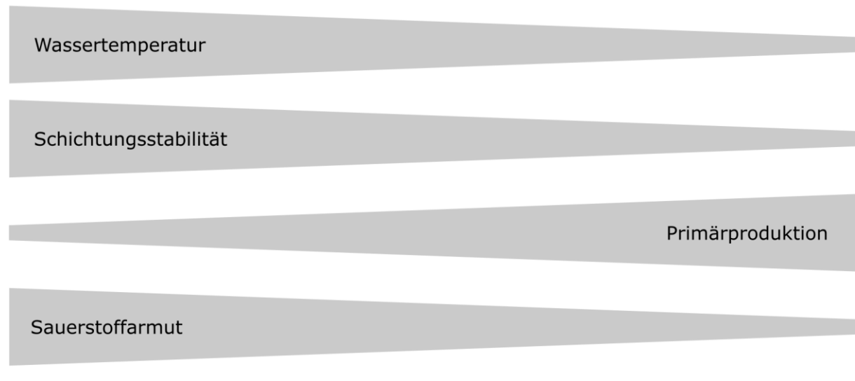
Abbildung 4.1: Einfluss einer FPV-Nutzung auf die Wassertemperatur, Schichtungsstabilität, Primärproduktion und Sauerstoffarmut eines Gewässers in Abhängigkeit des Durchflusses
