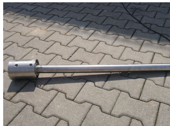
Abb. 4: Sondenschutz mit Befestigungsrohr
