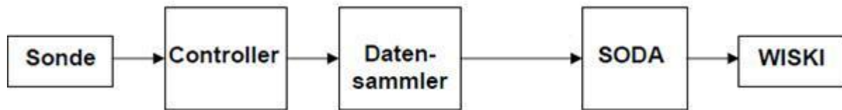
Abb. 5: Schematischer Aufbau der Datenübertragung
