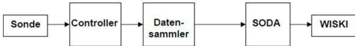
Abb. 5: Schematischer Aufbau der Datenübertragung
