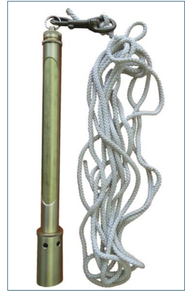
Abb. 8: Schöpfthermometer mit geschlossenem Skalenschutz
