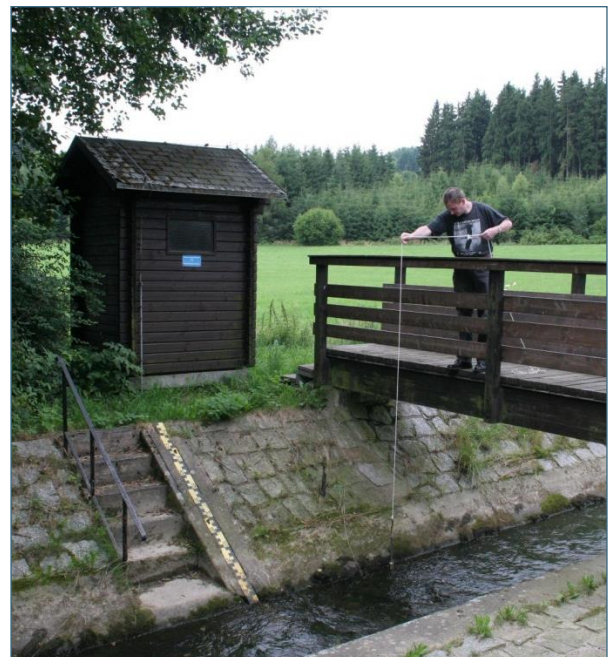
Abb. 10: Einbringen des Schöpfthermometers ins Wasser von einem Messsteg aus
