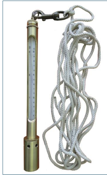
Abb. 7: Schöpfthermometer mit geöffnetem Skalenschutz
