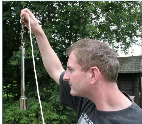
Abb. 11: Ablesen der Wassertemperatur von der Skala des Schöpfthermometers
