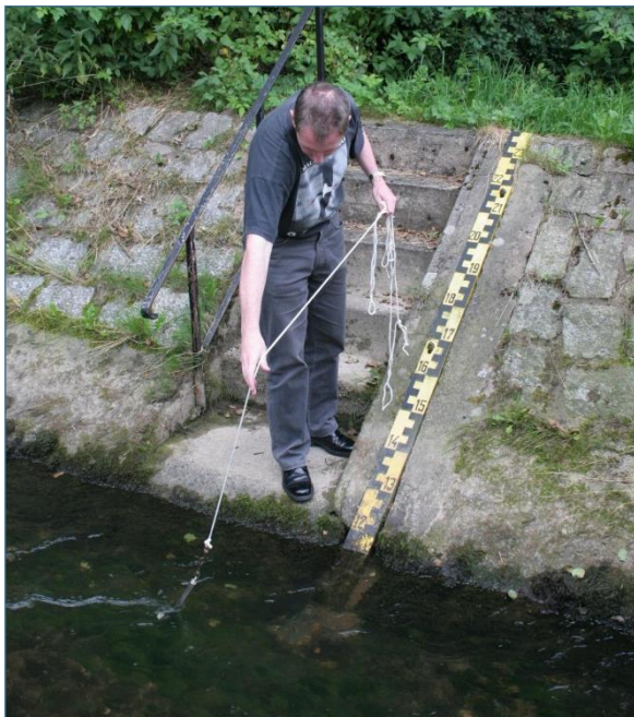
Abb. 9: Einbringen des Schöpfthermometers ins Wasser von der Pegeltreppe aus
