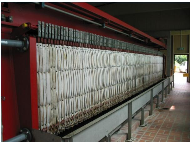
Abb. 21: Kammerfilterpresse
