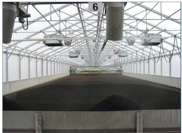
Abb. 22: solare Trocknungsanlage
