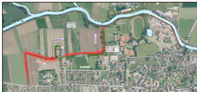
Abb. 4: Praxisbeispiel Ampfing; Hochwasserschutz durch Deiche sowie Erhöhung von Wegen und Gelände (mit ökologischen Ausgleichsflächen). Quelle: Gemeinde Ampfing
