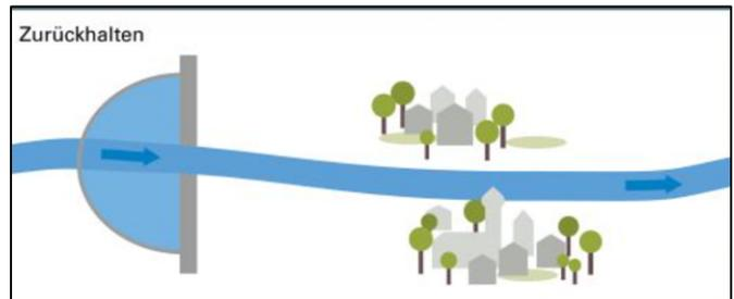
Abb. 1: Oben: Praxisbeispiel Pettendorf; Plan des Rückhaltedamms, Quelle: Gemeinde Pettendorf, unten: Schematische Darstellung der Wirkung eines Rückhaltedamms, Quelle: LfU
