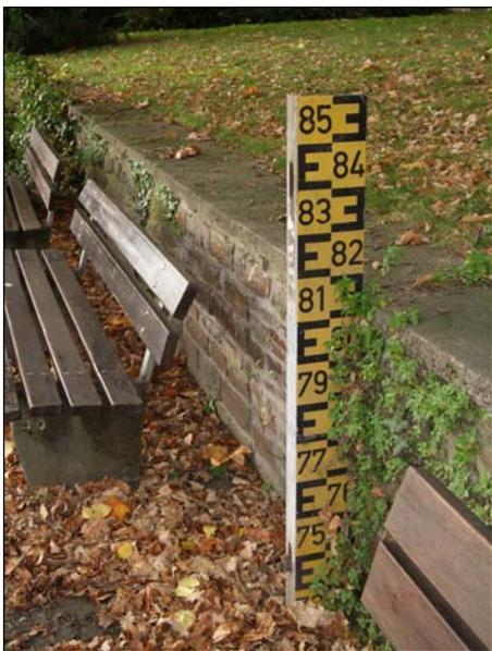
**Abbildung 9 Pegelmesslatte zur Bestimmung des Wasserstandes**
