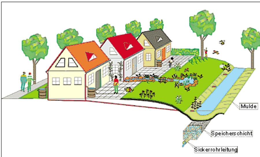
**Abbildung 16 Mulden-Rigolen-System zur dezentralen Versickerung von Regenwasser**
