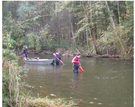
Elektrobefischung in einem Fluss
