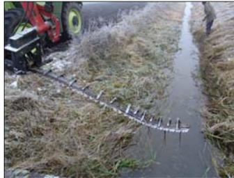
Spezialmaschine: gebogener Messerbalken am Auslegearm
