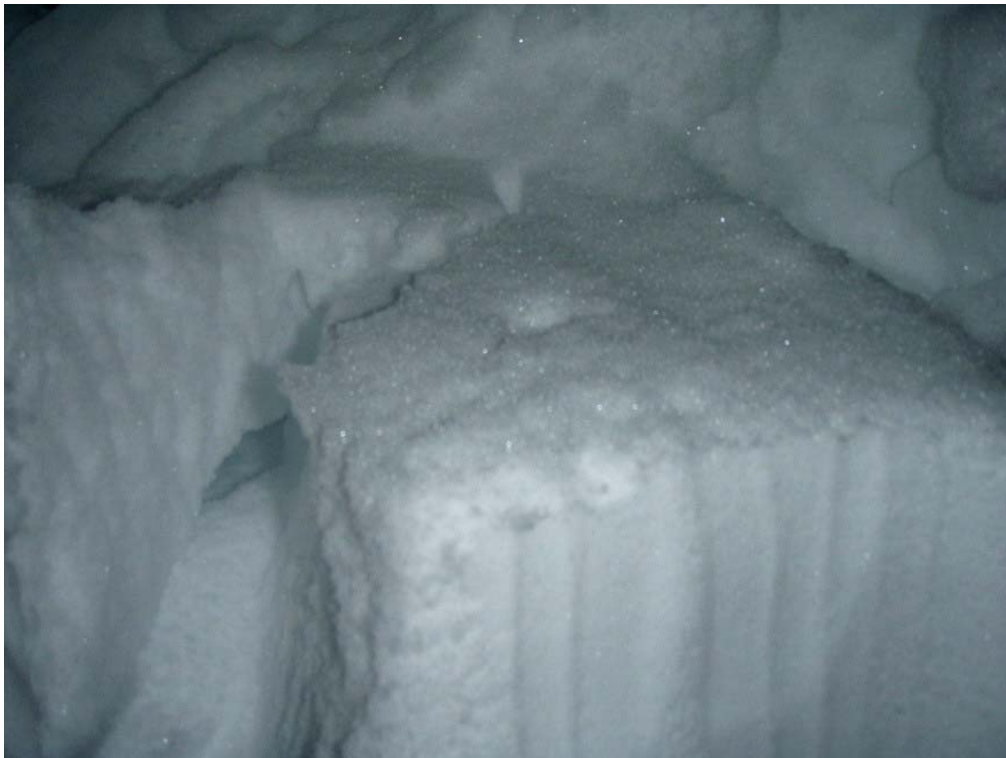
Im Blocktest ist die Schicht großer, kantiger und bindungsarmer Schneekristalle, die unter dem oberflächlichen Harschdeckel entstanden ist, als Schwachschicht zu erkennen. Foto: Kristian Rath
