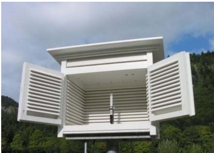
Abb. 40: Widerstandstemperaturmessung bei der Klimastation Syl- vensteinspeicher
