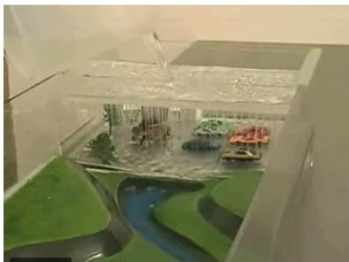
Abb. 66: Durch Zugabe von Wasser wird die Beregnung einer versiegelten Parkplatzfläche simuliert.
