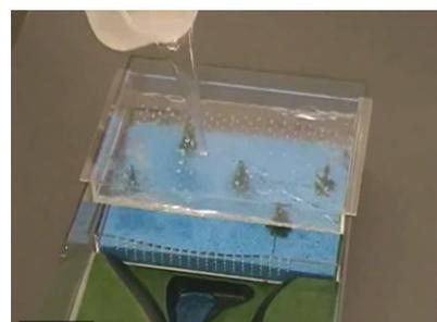
Abb. 71: Das Einsetzen von Schwämmen simuliert die Retentionswirkung von Auen- und Forstgebieten.
