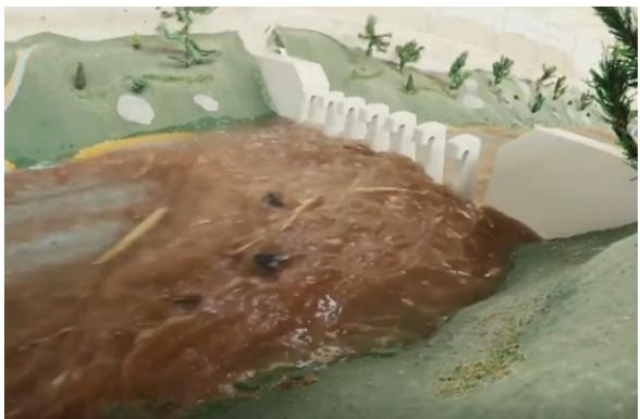
Abb. 32: Wirkung einer Dosiersperre im Modell mit Wildholz
