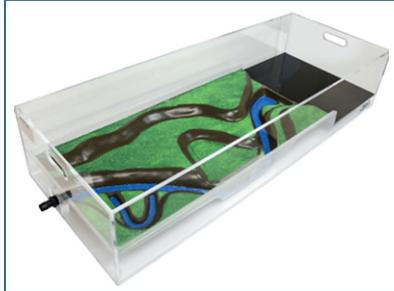
Abb. 63: Stormwater Floodplain Modell mit Fließrichtung von rechts nach links
