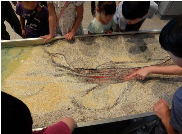
Abb. 78: Mit farbig codierten Sedimenten können Korngrößen-spezifische Transportphänomene visuell unterschieden werden.
