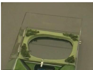
Abb. 69: Im Einlauf wird ein Rückhaltebecken zur Retention angelegt.
