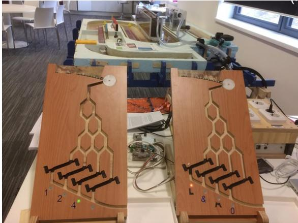
Abb. 74: Galton-Bretter zur Einsteuerung der Niederschlagsdauer und -intensität als auch des Niederschlagsortes
