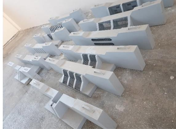
Abb. 29: Verschiedene Bauformen von Geröllsperren wurden bisher im Modell getestet und vorgeführt.
