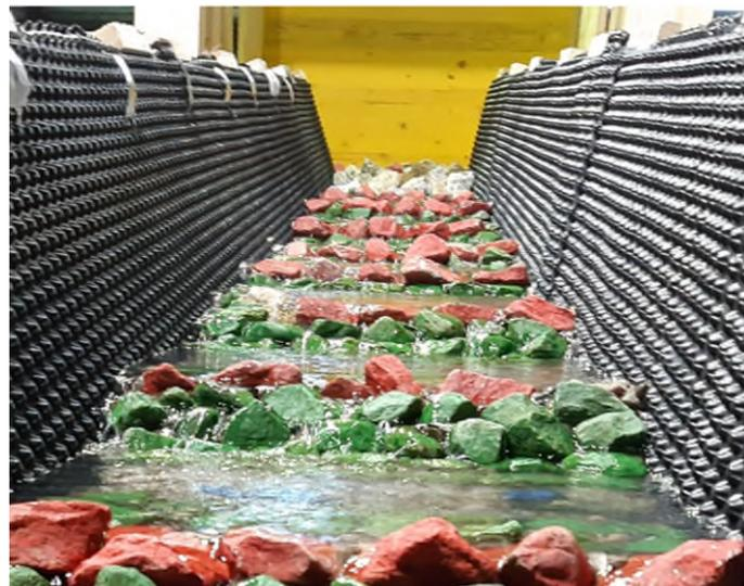
Abb. 35: Untersuchung der Sohlenstabilisierung der Maira bei Promontogno durch ein Stufen-Becken System
