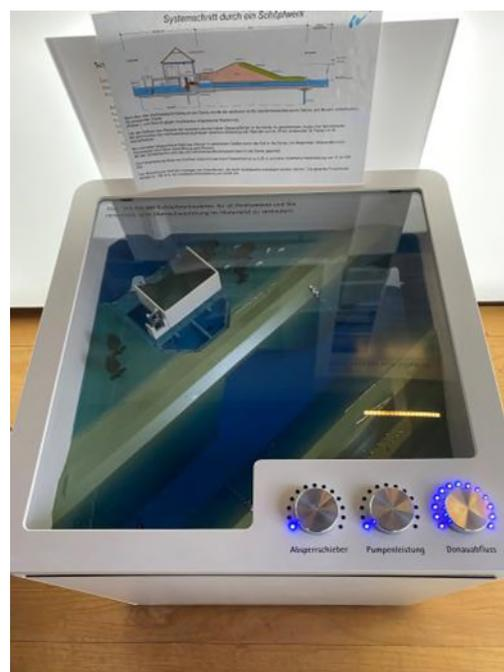
Abb. 59: Modell des Schöpfwerkes bei einer Hochwassersituation in der Donau
