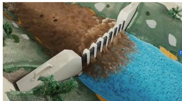
Abb. 33: Wirkung einer weiteren Variante der Dosiersperre im Modell mit Wildholz
