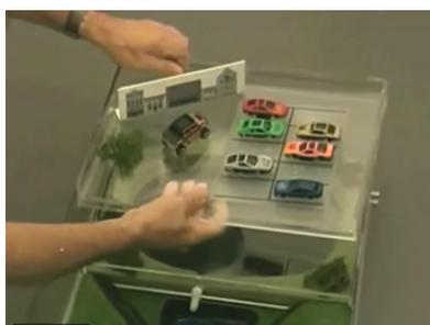
Abb. 70: Über dem Rückhalteraum wird der Parkplatz montiert.
