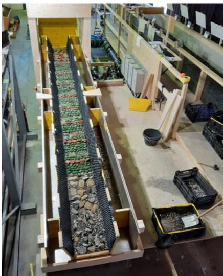
Abb. 34: Modell für die Flussbaumaßnahmen an der Maira im Laboratorium3D
