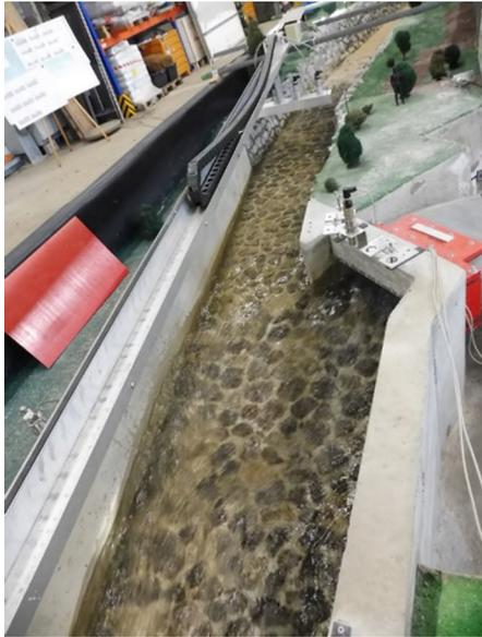
Abb. 50: Zusammenfluss der beiden Wildbäche im Ortsgebiet Bayrischzell im Modell. Der Wendelsteinbach fließt von oben nach unten und der Larchbach mündet von rechts ein.
