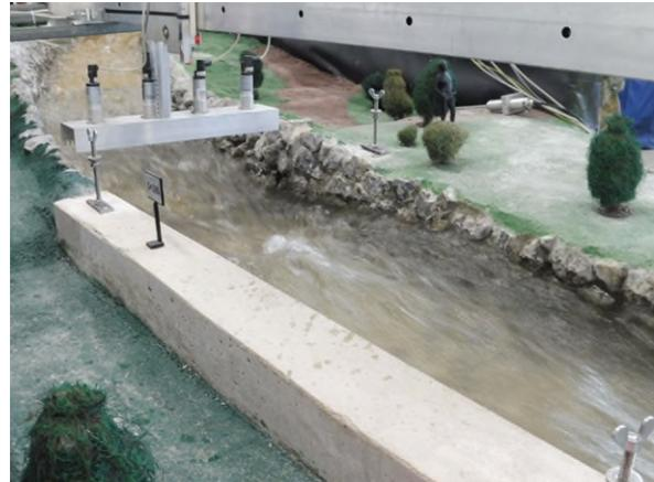
Abb. 51: Im Falle des HQ<sub>100</sub> im Wendelsteinbach wird die Ortschaft durch eine Wand aus Wasserbausteinen und eine Hochwasserschutzwand geschützt.
