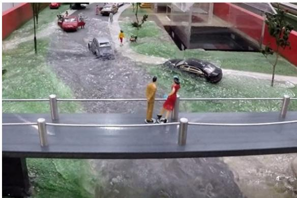
Abb. 16: Beginn der Sturzflut mit Erfassung der Autos und Personen (Fließrichtung von unten nach oben im Bild).
