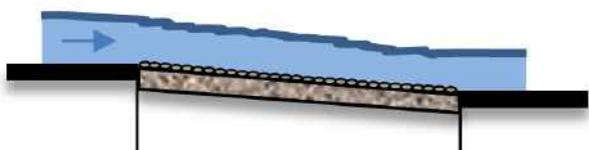
Abb. 18: Schematische Darstellung einer Sohlengleite
