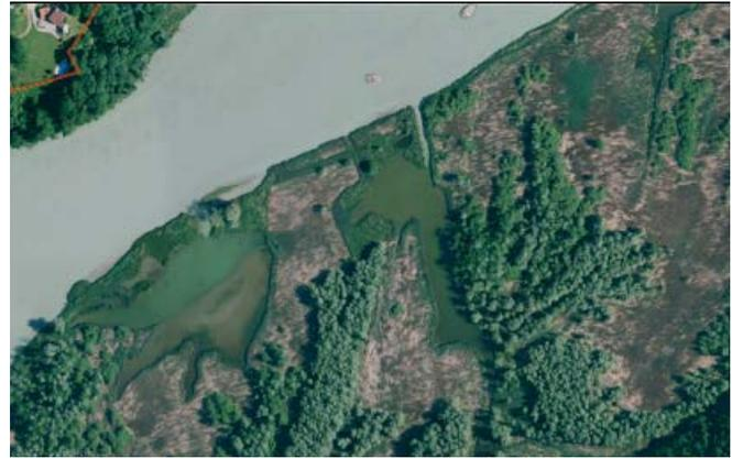
Abb. 11 a und 11b: Inn, Staustufe Wasserburg: Stauraumstrukturierung Freihamer Au (vorher-nachher-Vergleich); links sind die geplanten Gestaltungsmaßnahmen rot eingezeichnet, (Quelle: [www.geodaten.bayern.de](http://www.geodaten.bayern.de))
