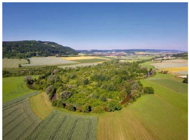
Abb. 8: Altmühl bei Treuchtlingen: Laufverlängerung und Neuanlage von 15 ha Auwald, (Quelle: WWA Ansbach)
