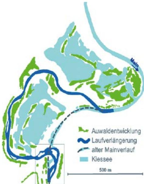
Abb. 9: Obermain: Planarstellung zur naturnahen Flussentwicklung mit Laufverlängerung und Verbesserung der Fluss-Aue-Vernetzung
