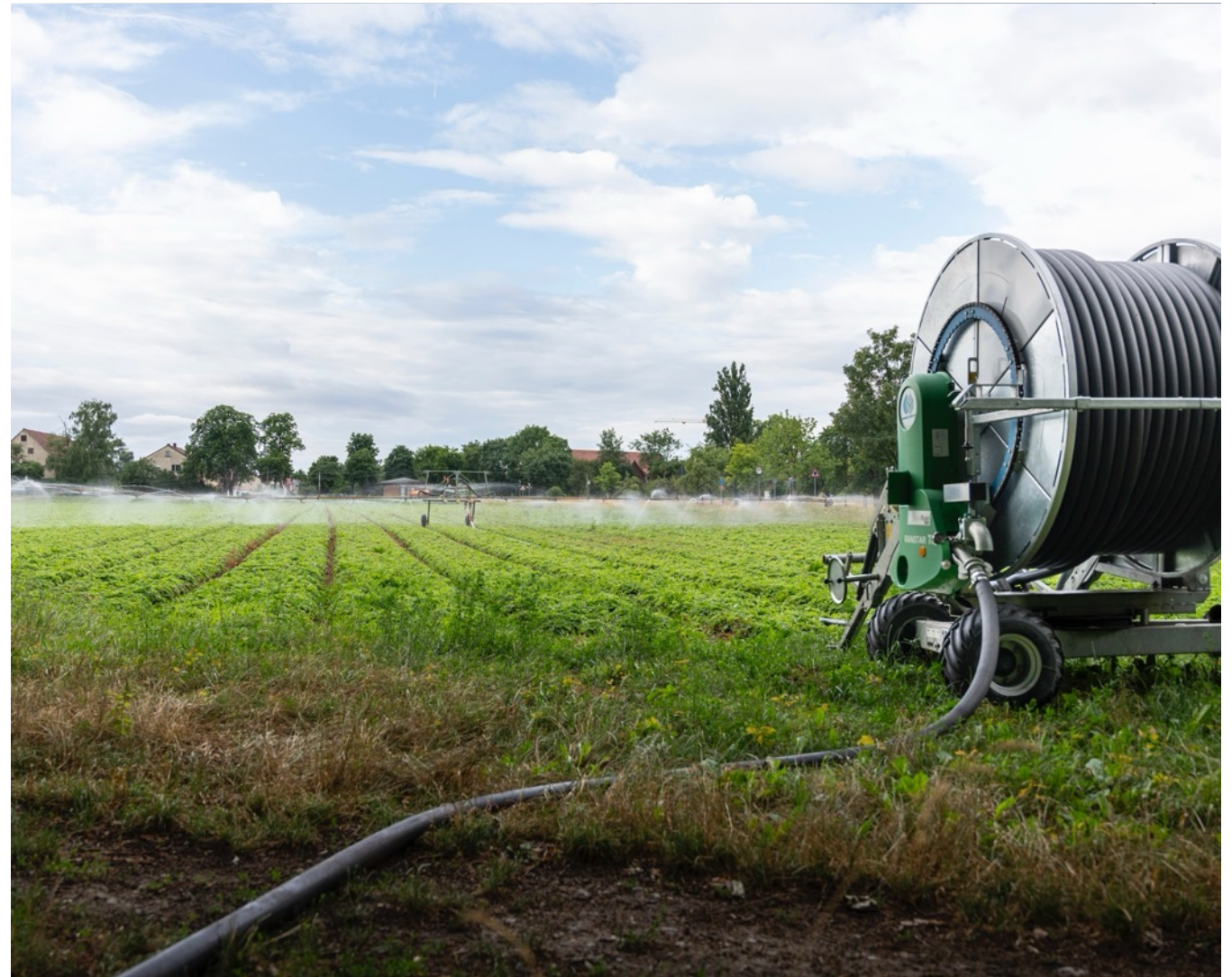
Beregnungsmaschine mit Düsenwagen zu Frauenmantel (Heilkraut)
