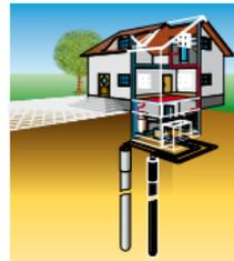
Bei kleinen Grundstücken sind Erdwärmesonden besonders geeignet.
