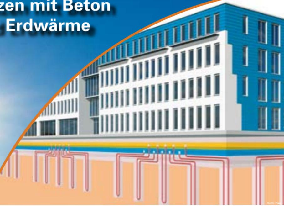
Bei Großbauwerken sind aus statischen Gründen teils tief in den Untergrund reichende Betonstrukturen wie z. B. Gründungspfähle, Schlitz- oder Pfahlwände notwendig. Beton hat eine gute Wärmeleitfähigkeit und ist ideal zur Gewinnung und Speicherung von Wärme und Kälte.
