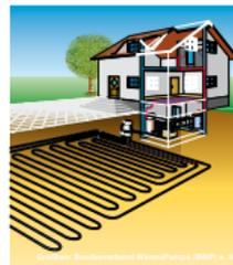
Wenn eine große Grundstücksfläche zur Verfügung steht, bieten sich z. B. horizontal verlegte Kollektoren an.
