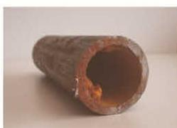
Materialalterung, Korrosion und fehlerhafte Rohrverlegung sowie frostbedingte Bodenbewegungen zählen zu den Verursachern von Rohrbrüchen.
