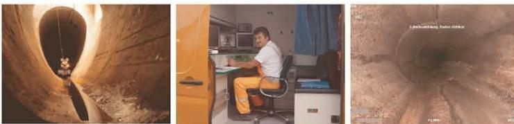
Die Kanalkamera wird von einer Schaltzentrale an der Oberfläche gesteuert. Anhand der Bilder und Daten, die sie sammelt, können Schäden festgestellt und bewertet werden. Diese Dokumentation ist die Basis für Sanierungsmaßnahmen.
