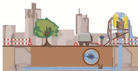
Der Schlauch wird dann mit Druck an das beschädigte Rohr gepresst. Ist das Herz ausgehärtet, entsteht so ein neues „Rohr im Rohr“.
