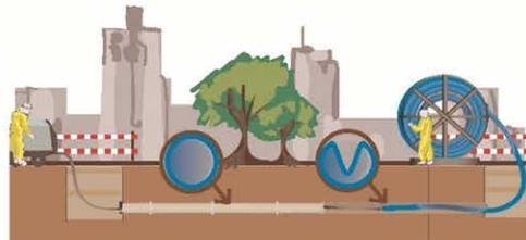
Durch Dampf und Druck entfaltet sich das Kunststoffrohr und schmiegt sich an das alte Bestandsrohr an. Das neu eingezogene Rohr ist statisch selbsttragend.
