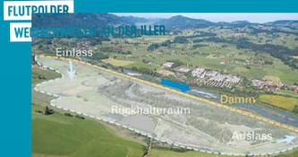
Ein Flutpolder ist ein Rückhalteraum, in den bei sehr großen Hochwassern gezielt Wasser gefüllt wird.
