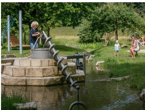
Abb. 49: Wasserspielplatz mit Archimedischer Schraube und Stauerelementen im ausgeleiteten Bach (Anlauter in Kinding, Oberbayern)
