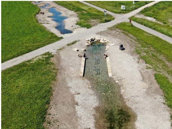
Abb. 45: Kneippanlage in einer geöffneten Drainageleitung (Isar (Flutmulde) in Landshut, Niederbayern)
