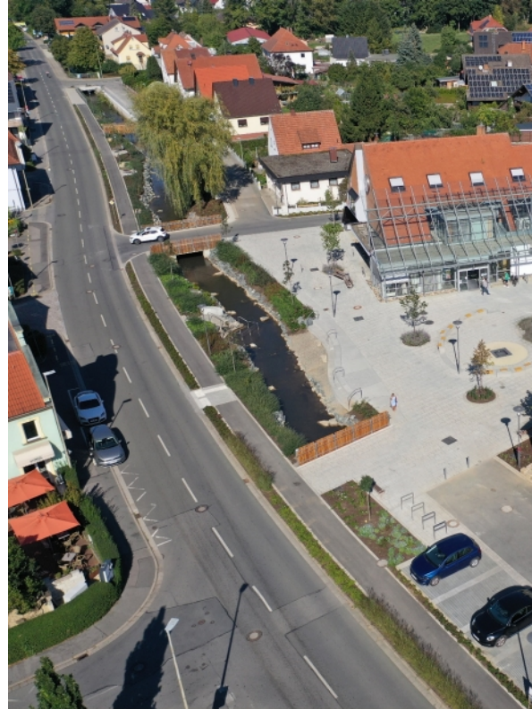
Abb. 149: Nachher: Aufwertung durch die Öffnung und naturorientierte Gestaltung des Bachs mit Sitzmöglichkeiten und Naturkneippanlage in beengter Siedlungslage (Alte Weismain in Altenkunstadt, Oberfranken)
