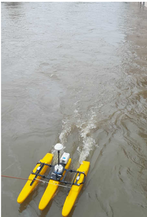
Abb. 20: Abflussmessungen des WWA Ingolstadt mit einem ADCP Messboot am Pegel Manching/Paar (Foto: WWA Ingolstadt)
