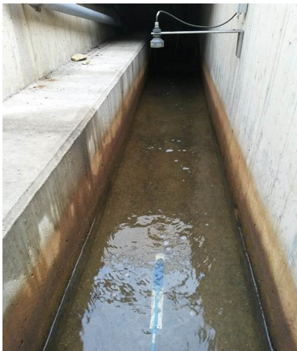
Abb. 10: Beispiel Ultraschall-Dopplerverfahren in einem Gerinne
