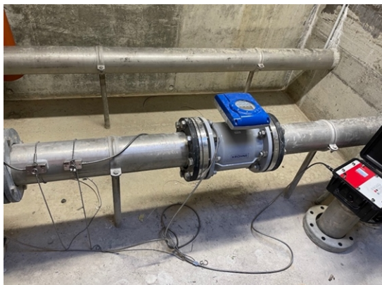
Abb. 9: Beispiel eines Aufschnallgerätes (Clamp-On)
