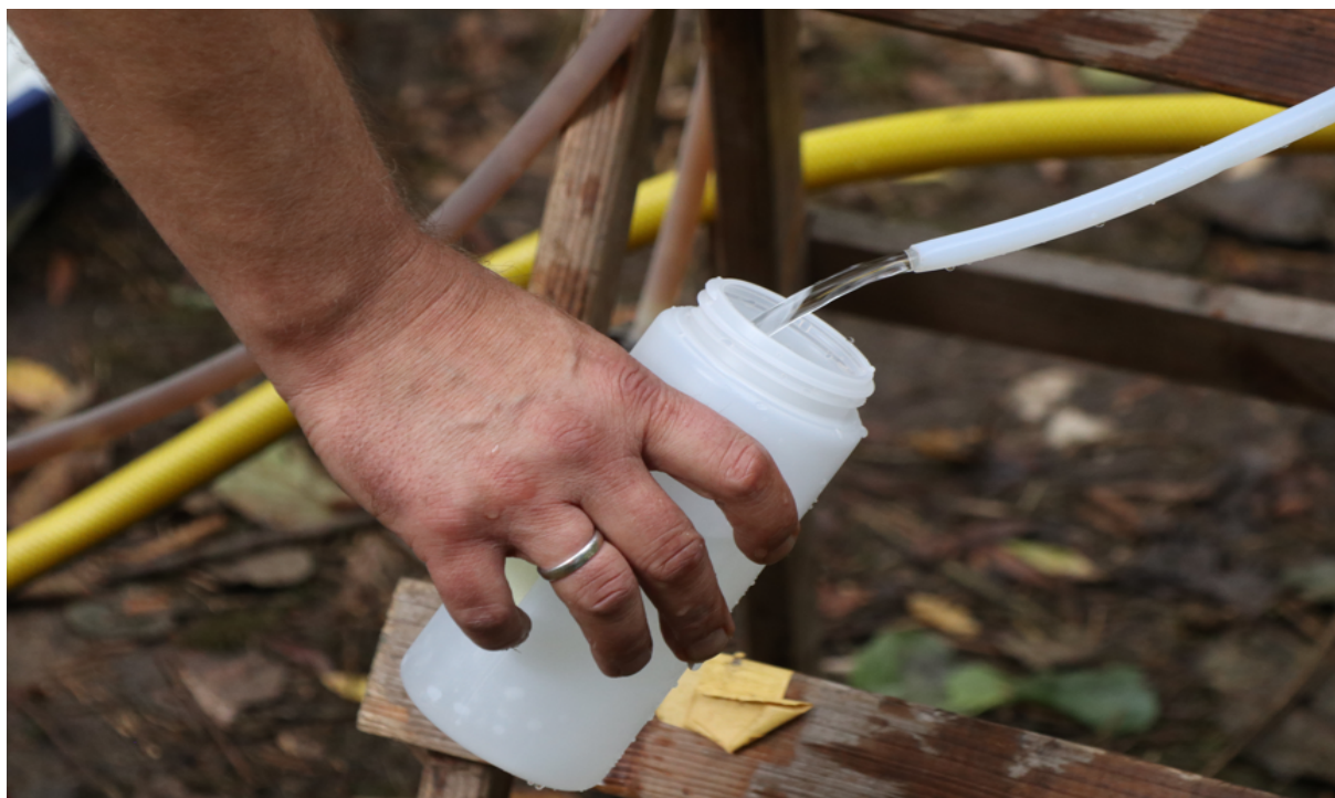
Abb. 14: Fotobeispiel zur Kategorie „Normative und fachliche Vorgaben nicht beachtet“ –Miniskus-Befüllmethode nicht angewendet und zu hoher Volumenstrom
