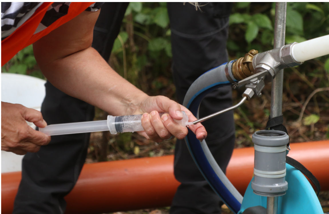
Abb. 11: Fotobeispiel „Fehlbedienungen, falsche Handhabung“ – Lufteintrag in Spritze
