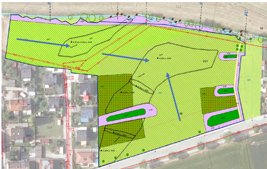
Abb. 24: Neugestaltung einer ehemaligen Ackerfläche (ca. 2 ha) mit Mulden zum Rückhalt in der Fläche, Ufergestaltung einschließlich einer Aufenthaltsmöglichkeit am Gewässer, Pflanzriegel und einer extensiven Wiese. Blaue Pfeile = Fließrichtung des Oberflächenwassers in neuzuschaffende Mulden (ohne Maßstab). © Geobasisdaten: Bayerische Vermessungsverwaltung
