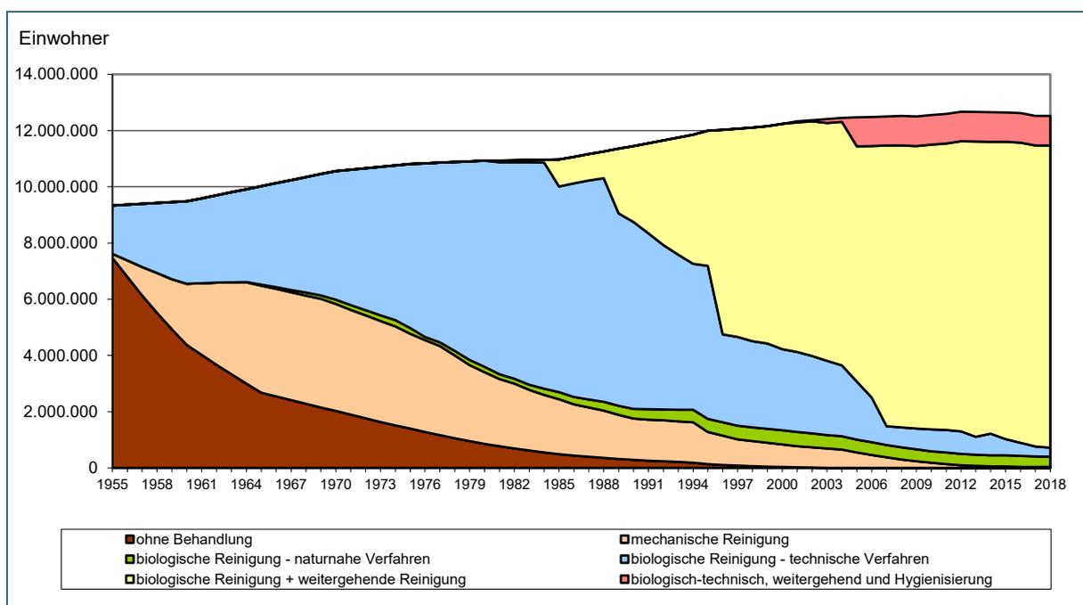
Abb. 11: Reinigungsniveau des kommunalen Abwassers in Bayern von 1955 bis 2018
