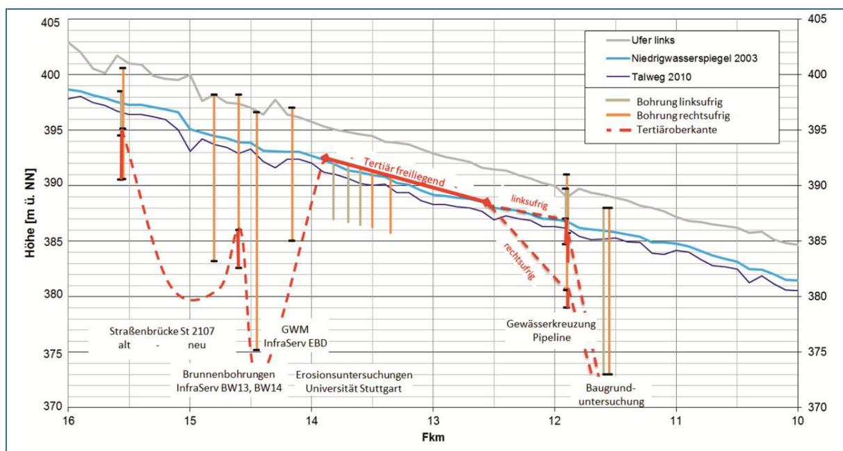
Abb. 5: Längsschnitt zwischen Fkm 16,0 und 10,0 mit Bohrungen und Lage der Tertiäroberkante
