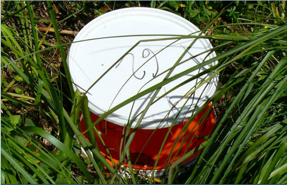
Abb. 10: Bodenfalle in der Untersuchungsfläche Fellhorn südlich des Kanzelwandhauses mit Regenschutz. Zu sehen ist der präparierte Trichter (orange), der passend in den versenkten Eimer eingesetzt ist.
