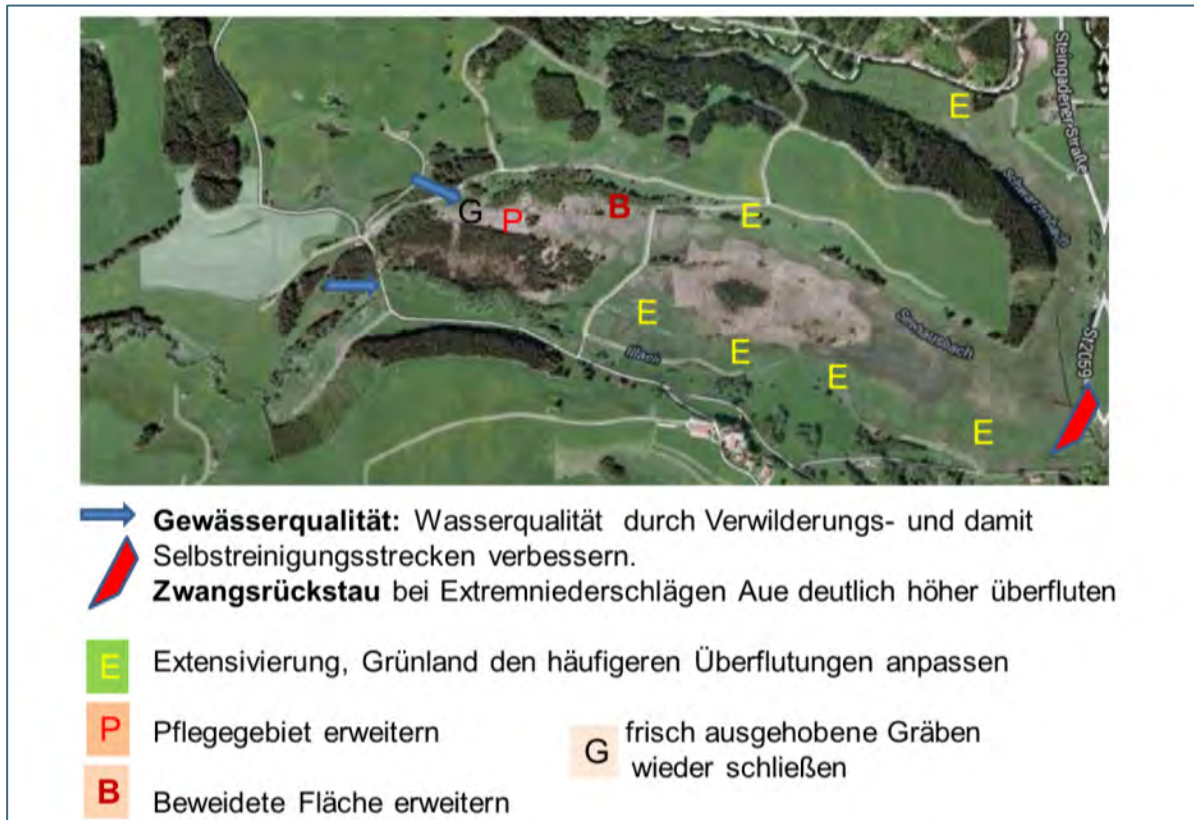
Abb. 83: Halbschematisches Maßnahmenkonzept für die integrierte Entwicklung eines Tales mit unterschiedlichen Moortypen und Maßnahmen innerhalb und außerhalb des engeren Schutzgebietes. Luftbild: © GoogleEarth.
