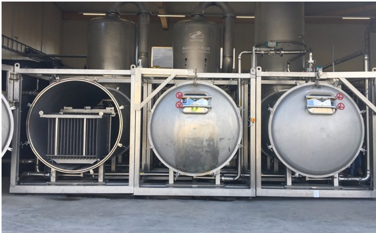
Abb. 17: AgriFer Plus-Vakuumverdampfer zur Herstellung von konzentriertem Ammoniakwasser nach Buchta
