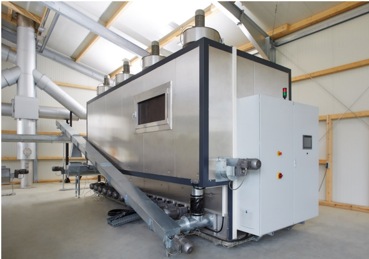
Abb. 18: Beispielanlage Rotationstrockner nach jumbo group smart dry GmbH
