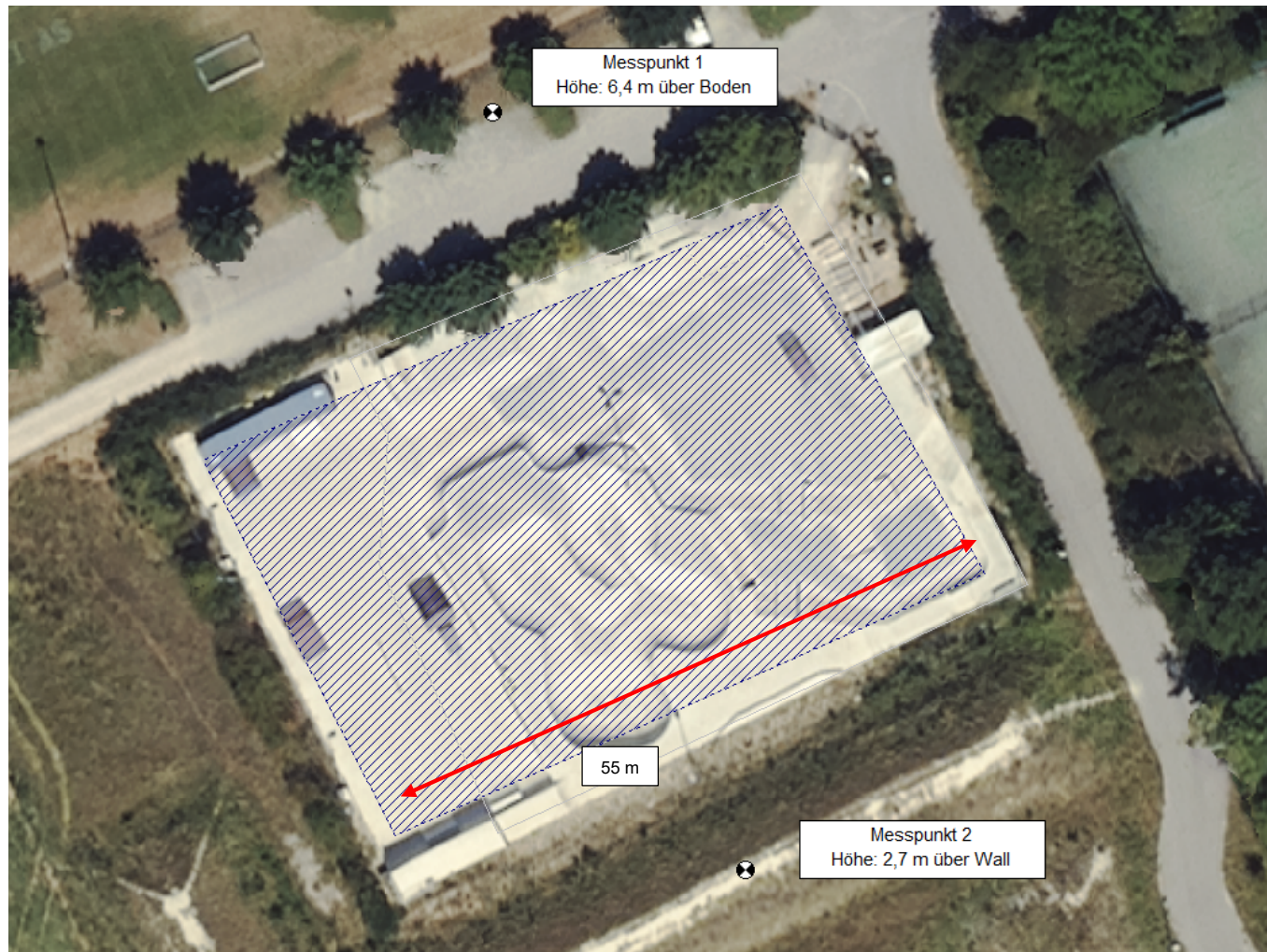
Abb. 64: Schallquellenplan Modell Skateplatz Unterschleißheim - Gesamtanlage
