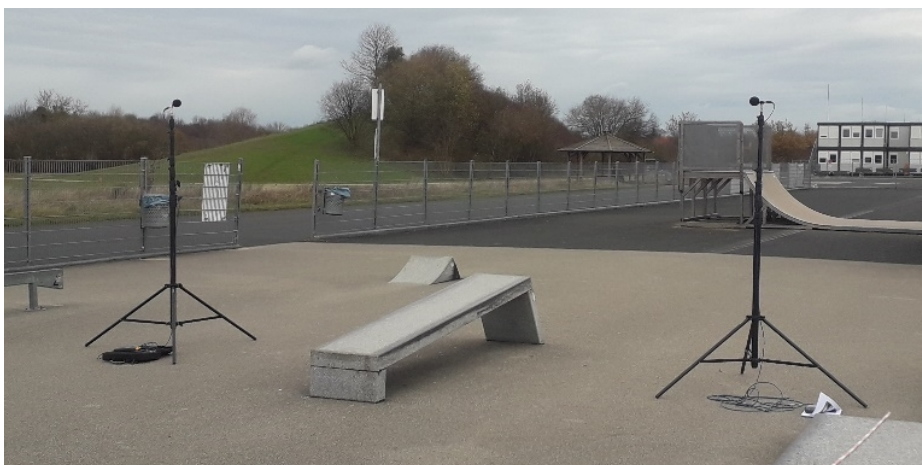
Abb. 15: Beispiel Messaufbau an einem schrägen Curb mit seitlichen Mikrofonpositionen
