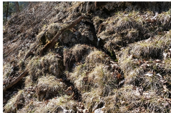
Abb. 22: Risse innerhalb der Rutschmasse, die auf anhaltende Bewegungen hinweisen
