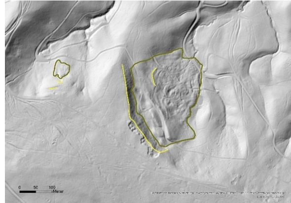
Abb. 5: Schattenbild einer tiefreichenden Rutschung östlich Murrleinsnest
