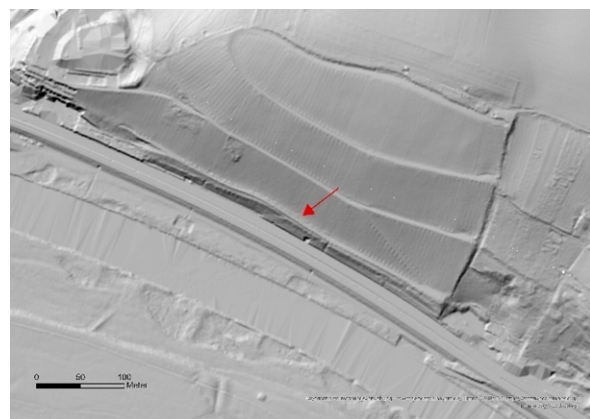
Abb. 3: Bei Hangversteilungen im Muschelkalk, wie hier zwischen Mainberg und Schonungen können herabfallende Steine nicht ausgeschlossen werden
