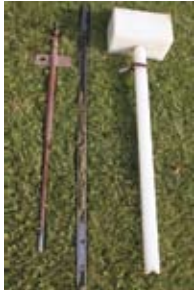
Mit dem Bohrstock entnimmt man eine 1 m lange Bodenprobe.
