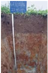
In solchen Profilgruben erfassen wir detailliert, wie der Boden geschichtet ist, und entnehmen Bodenproben.
