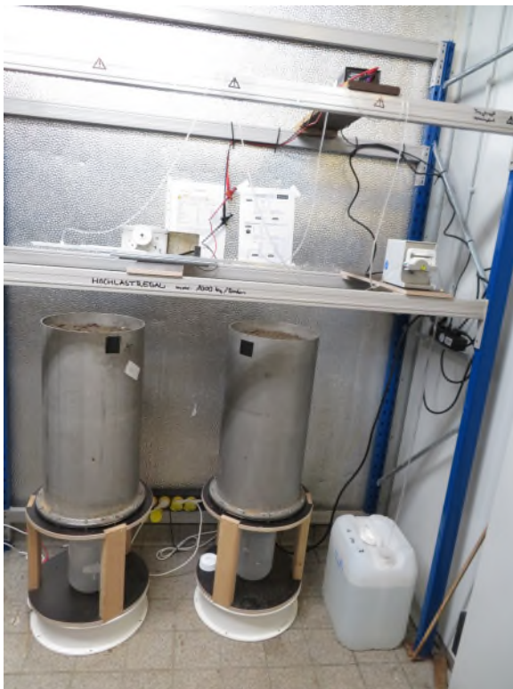
Abb. 6: Aufbau der Kleinlysime- ter im Kühlraum mit Beregnungsanlage
