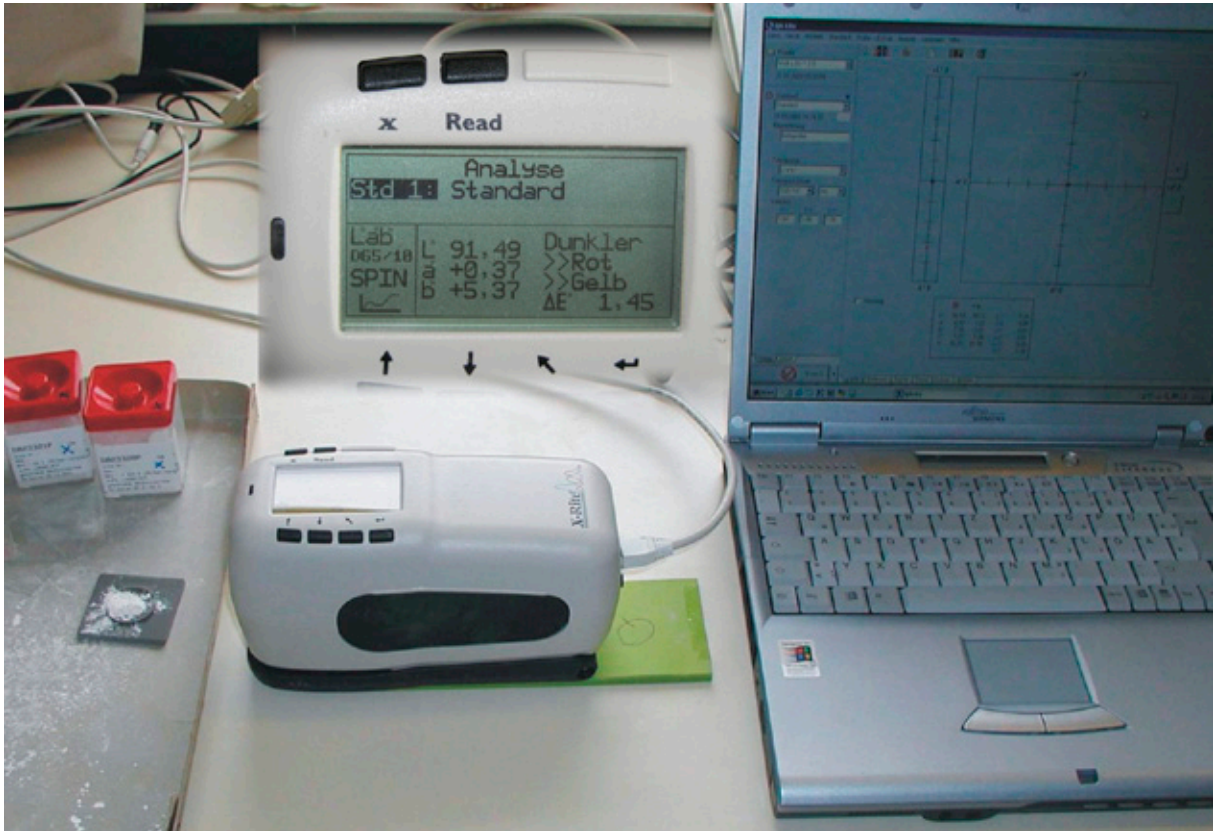
Abb. 3-4: Verwendetes Weißgradmessgerät (Spektralphotometer) der Firma X-Rite
