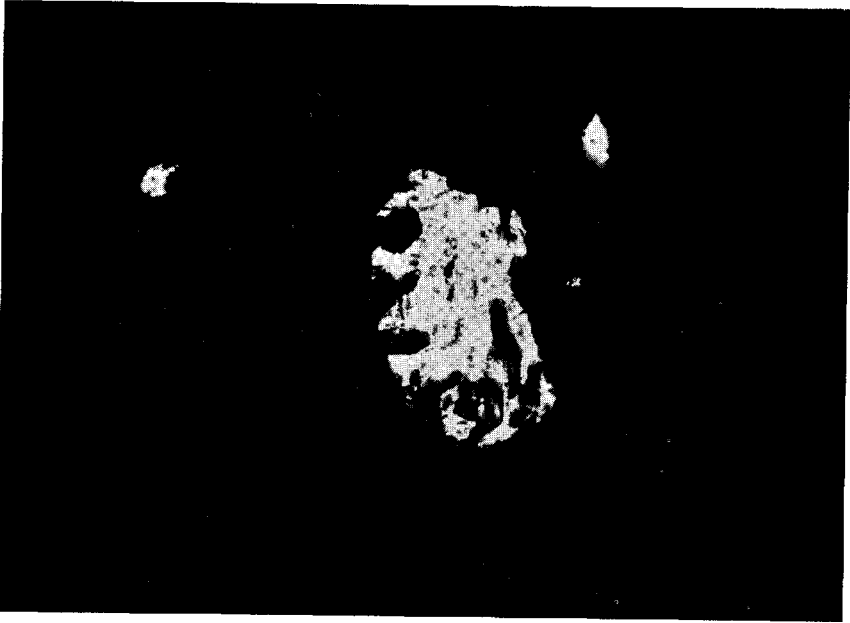
Abb. 25. Korrosionsbuchtenreicher Andalusit in Nadeleisenerz (schwarz). Nicols parallel, etwa 200fache Vergrößerung.
