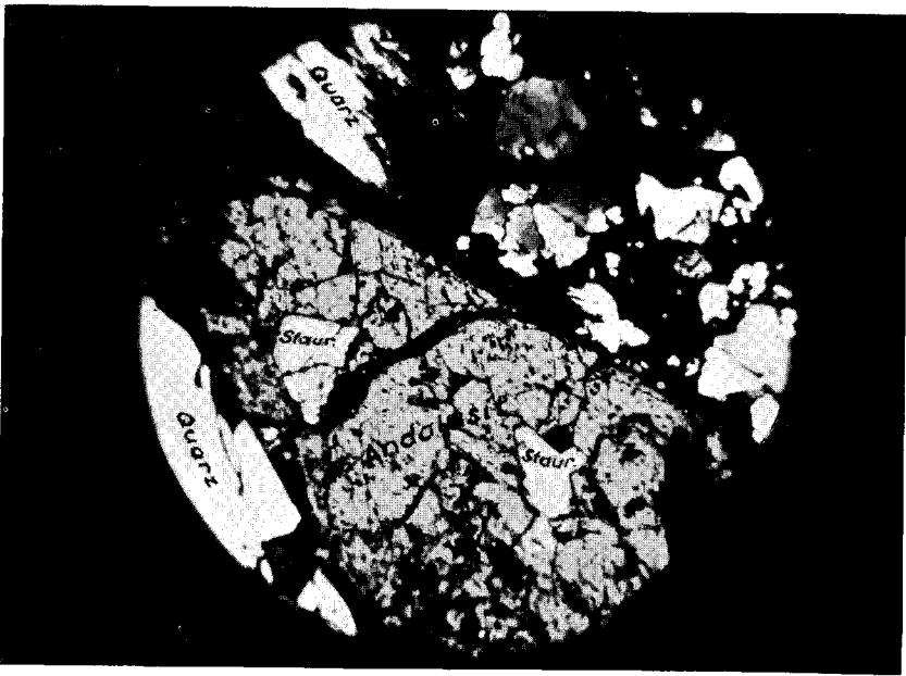
Abb. 26. In Psilomelan (schwarz) liegender und von Psilomelanschnüren durchzogener Andalusit (grauweiß) schließt Staurolith (weiß) ein. Im Andalusit ist Magnetit-si erkennbar. Nicols gekreuzt, etwa 30fache Vergrößerung.
