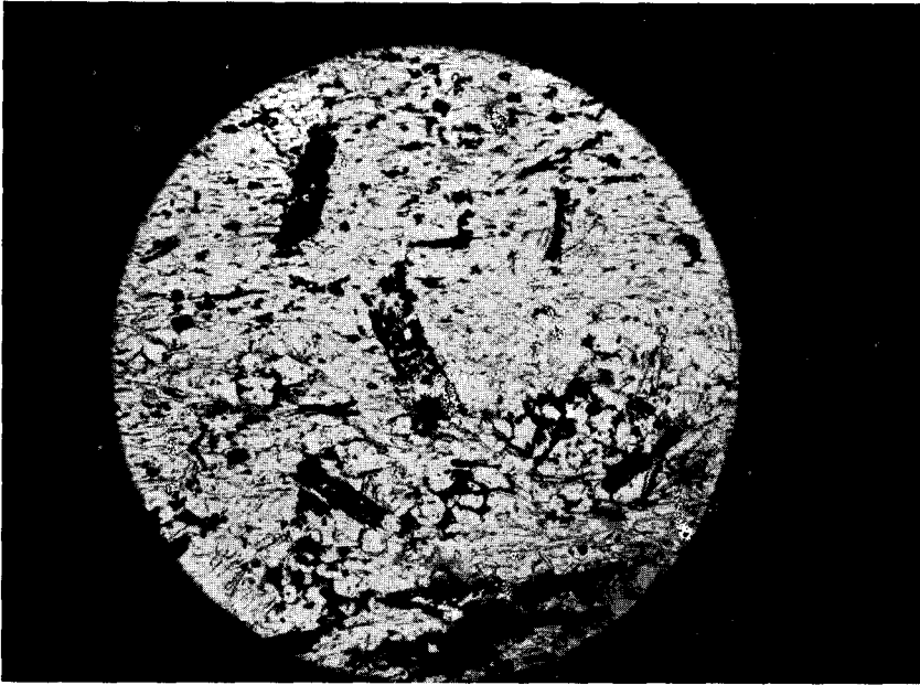
Abb. 18. In ss-||Serizitlagen treten Pseudomorphosen von Limonit nach Biotit (schwarz) auf. Kleine Hydrohämaitkörnchen (schwarz) finden sich bevorzugt im Serizit, etwas größere Hydrohämaitputzen in quarzreicheren Lagen (unteres Drittel). Nicols parallel, etwa 58fache Vergrößerung.
