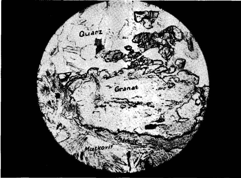
Abb. 9. Granat in der Grenzzone einer Muskovit- und einer rekristallisierten Quarzkornlage. In dieser erscheint Granat skelettartig und nicht chloritisiert, während er in der Muskovitlege hypidiomorph und randlich chloritisiert ist. Nicols parallel, etwa 58fache Vergrößerung.
