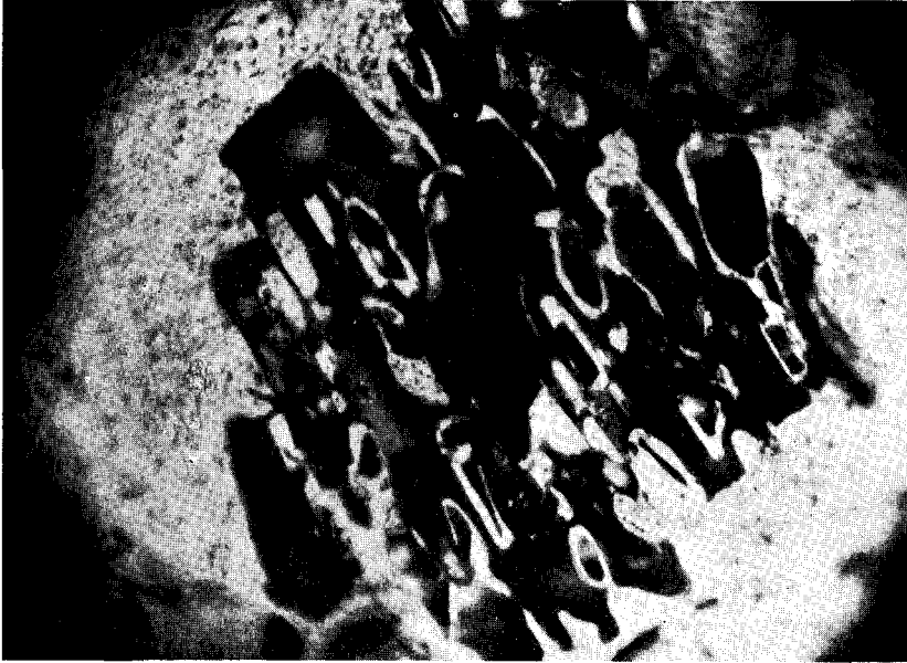
Abb. 24. In Hydrohämatit (weiß) liegendes Quarzkorn (grauschwarz bis schwarz) mit tiefen, gebogenen Korrosionsbuchten. Hydrohämatit erfüllt auch diese Hohlräume. Etwa 120fache Vergrößerung. Ölimmersion.
