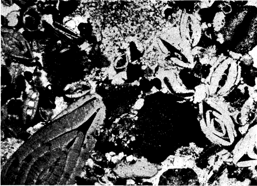
Abb. 18. Die Nummuliten sind mit Glaukonit oder Brauneisen als dessen Umwandlungsprodukt ausgefüllt. Vergr. 1 : 18.
