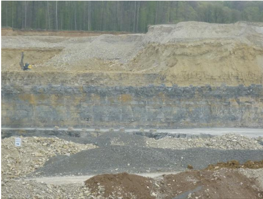
Abb. 29: Schotterwerk Schmitt: der Übergang vom Wel- lenkalk zum Mittleren Muschelkalk ist schon aus der Distanz am Farbum- schlag nach Gelb erkennbar. Über der durch Blöcke gesicher- ten Fahrstraße er- scheint bräunlich die 1. Schaumkalkbank. Der Bagger steht im Mittleren Muschelkalk. Ein entsprechendes Bild vermittelt im Maintal der Aufschluss des Zementwerkes in Karlstadt.
