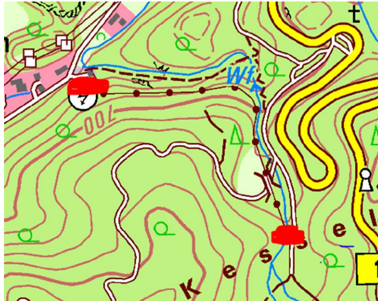
Abb. 11: Wasserkraftanlage Altjoch Wolf im Bereich des FFH-Gebietes (rot markiert, Leitung braun mit Punkten) (Grafik WWA-WM)
