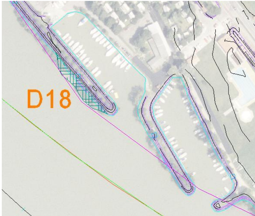
Abbildung 119: Uferstrukturierung durch Totholz und Kurzbuhnen an der Außenmauer des ersten Hafenbeckens in Obernzell.
