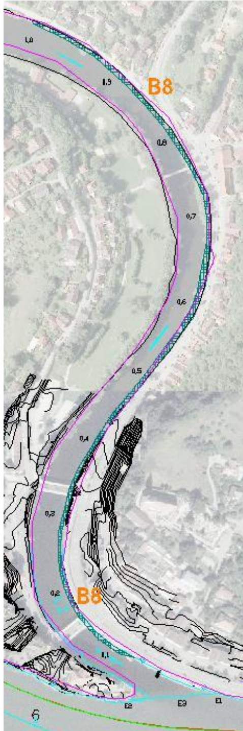
Abbildung 58: Ökologische Aufwertung des linken Uferbereichs der Ilz bis kurz oberhalb des Mündungs-bereiches durch Uferstrukturierungen.
