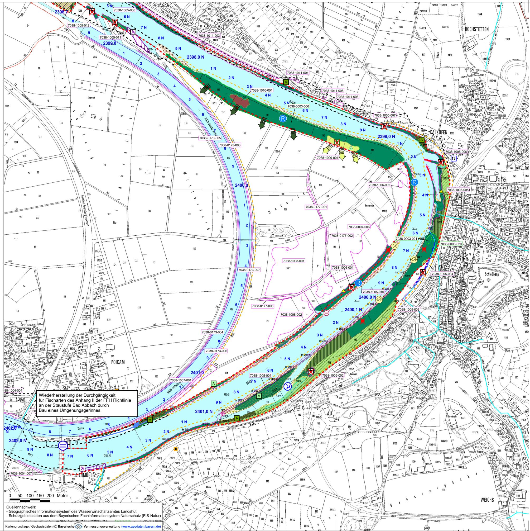
Wiederherstellung der Durchgängigkeit für Fischarten des Anhang II der FFH Richtlinie an der Staustufe Bad Abbach durch Bau eines Umgehungsgerinnes.
