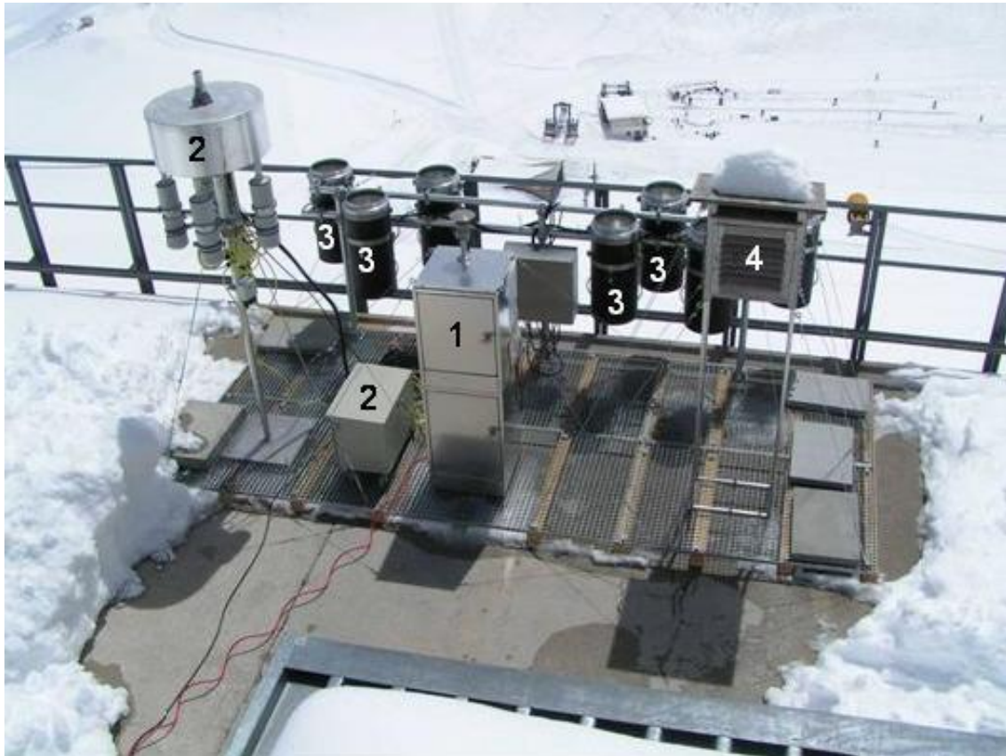
Abbildung 4: Messstandort an der Umweltforschungsstation Schneefernerhaus (UFS). 1 Low Volume Sampler (inklusive Steuereinheit), 2 High Volume Sampler, 3 Depositionssammler, 4 Schutzhütte für Passivsammler (SPMD), im Rahmen von POPALP nur im NP Berchtesgaden.
