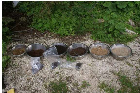
Abbildung 10: Proben von BG 3: L, Of+Oh, Ah, Bv-Ah, Bv-cCv, cICv (v. links nach rechts). Im Vordergrund LD-Proben in PE-Beuteln.
