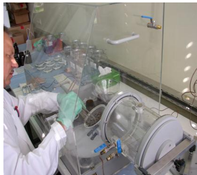
Abbildung 12: Entnadelung in einer Glovebox
