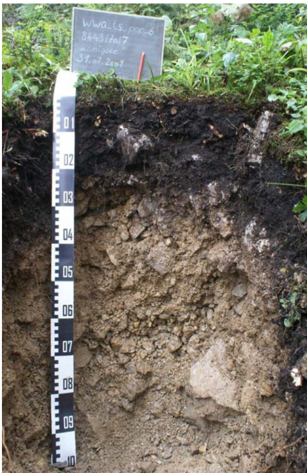
Abbildung 130: Bodenprofil BG 6 (Rendzina)
