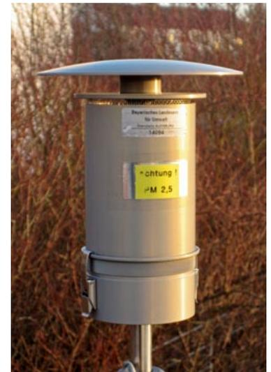
*Staubabscheider für  $PM_{2,5}$  auf der Ansaugleitung der Messstation und Innenansicht (Abscheidedüsen)*
