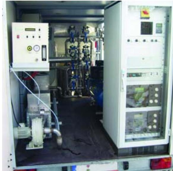
Mobile NTO-Testanlage für Reinigung und Messung der Abluft
