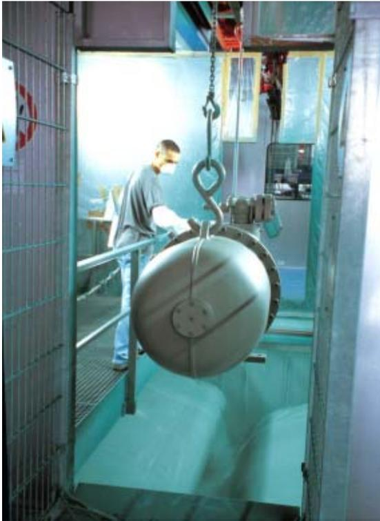
Abb. 2: Dieser Kühlmaschinenhersteller kann dank Einsatz von Wasserlack auf eine Abluftreinigung verzichten. (Foto EISENMANN)
