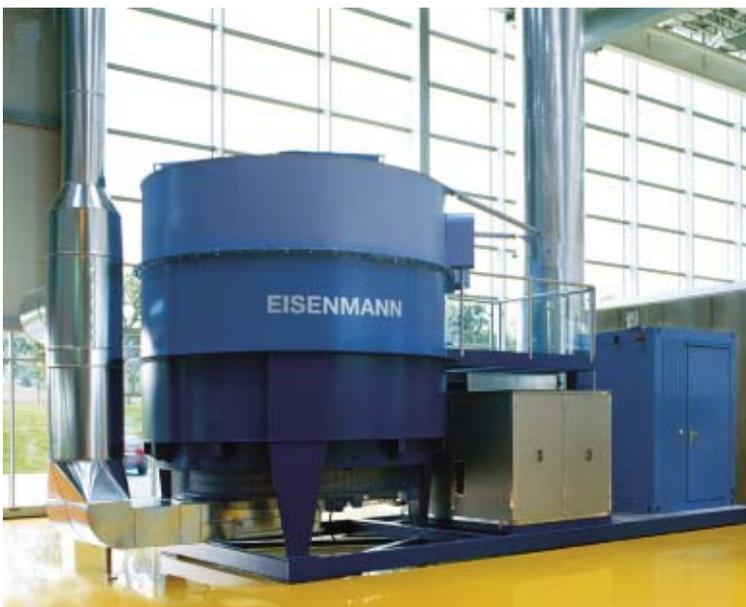
Abb. 9: Vormontierte Kompakt-RNV beim Werksprobelauf (Foto EISENMANN)
