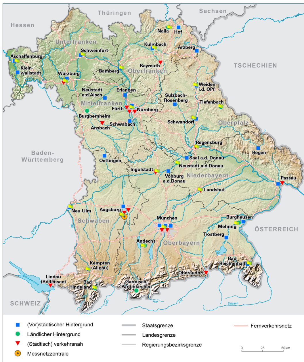
Abb. 1: Karte mit LÜB-Messstationen. Standorte mit Windmessung sind mit einem gelben Fähnchen markiert.
