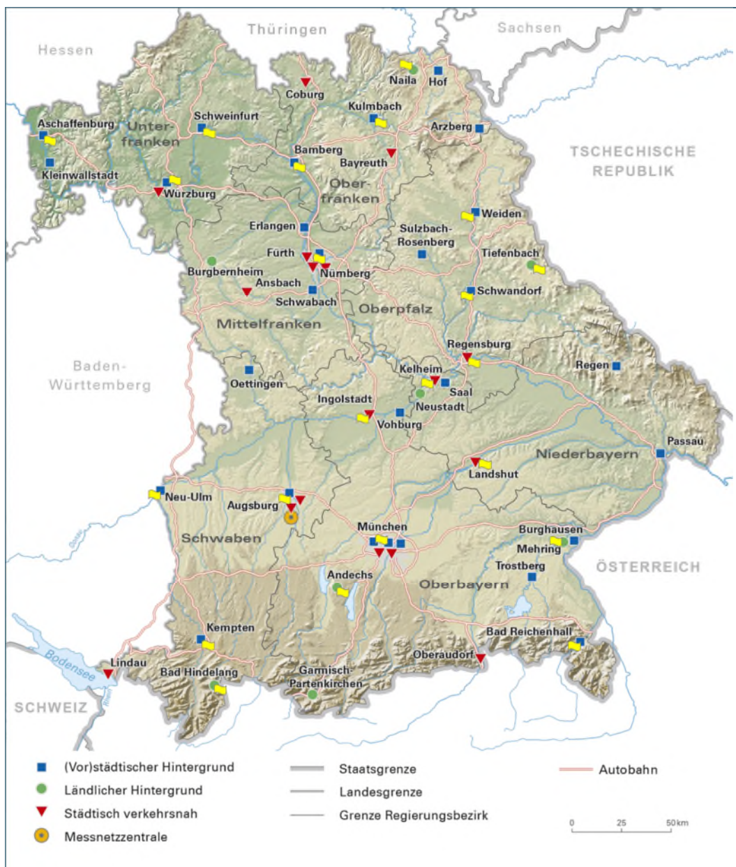
Abb. 1: Karte mit den Messstationen des Lufthygienischen Landesüberwachungssystems Bayern (LÜB). Standorte, die auch Windrichtung und Windgeschwindigkeit erfassen, sind mit einem gelben Fähnchen markiert.
