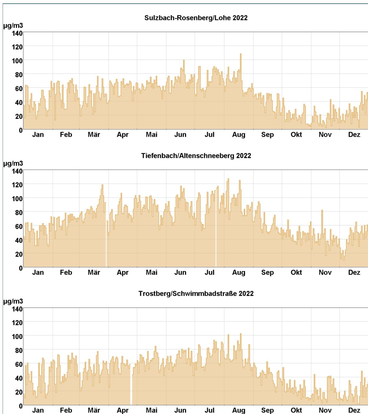
Abb. 12: Tagesmittelwertverläufe von Ozon an den mit Ozonmonitoren ausgestatteten LÜB-Messtationen.
