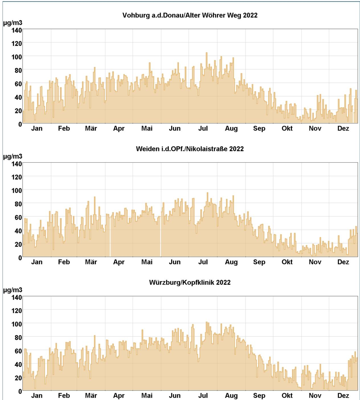
Abb. 13: Tagesmittelwertverläufe von Ozon an den mit Ozonmonitoren ausgestatteten LÜB-Messtationen.
