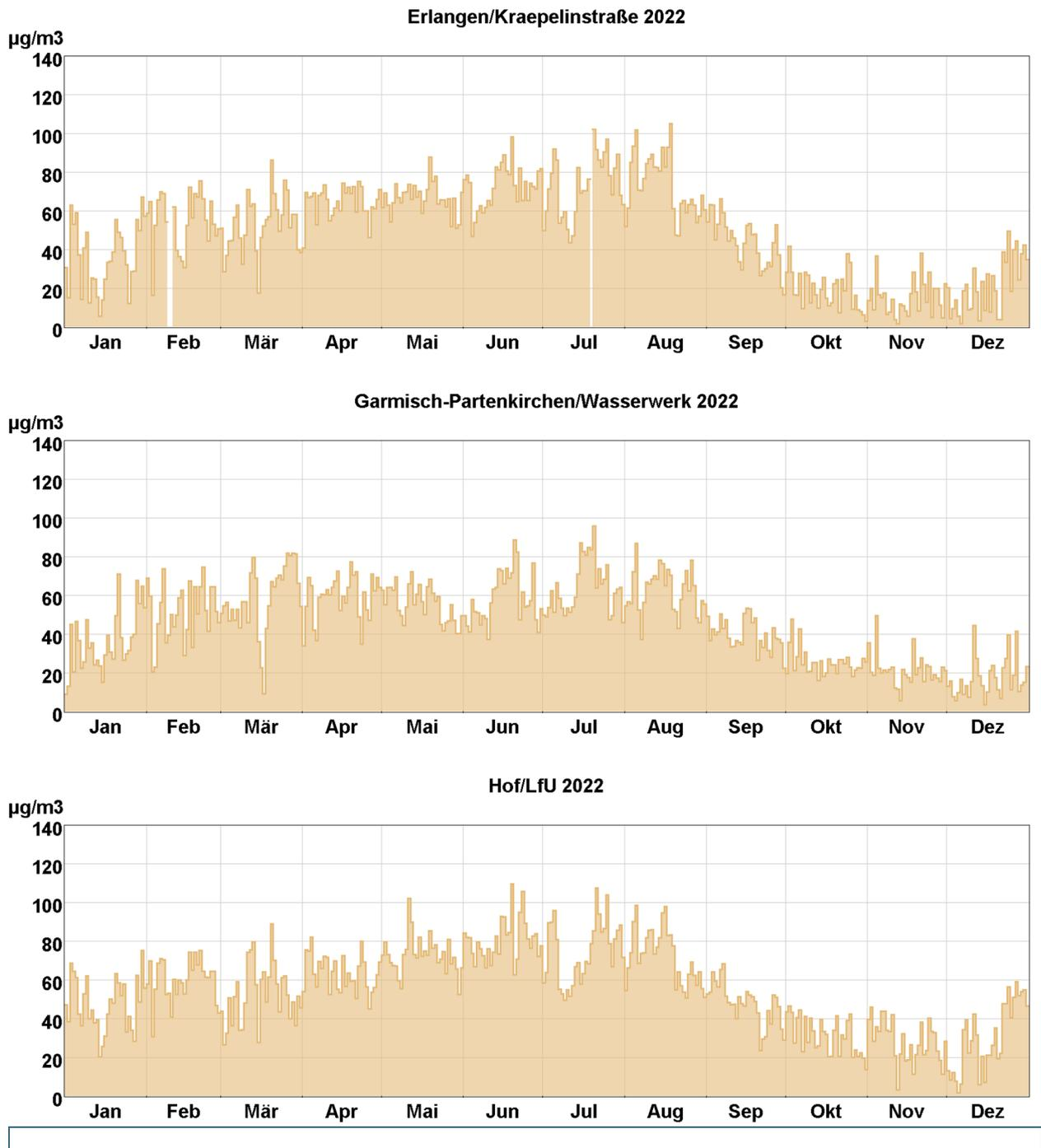
Abb. 5: Tagesmittelwertverläufe von Ozon an den mit Ozonmonitoren ausgestatteten LÜB-Messtationen.
