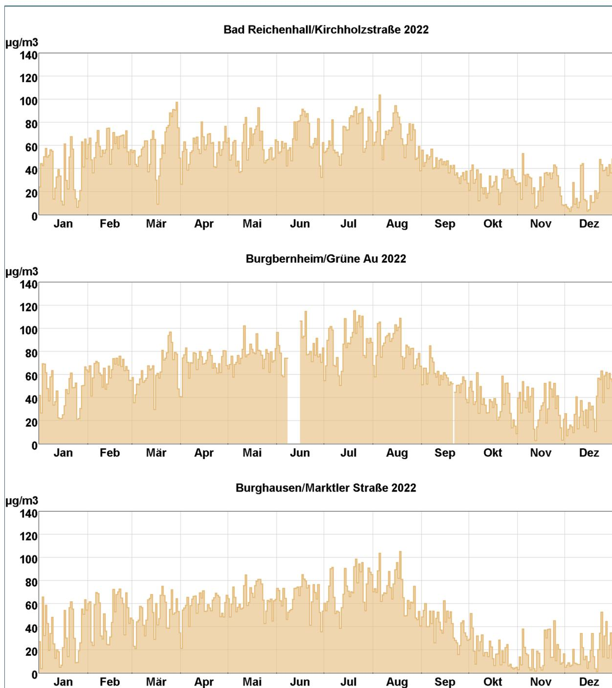
Abb. 4: Tagesmittelwertverläufe von Ozon an den mit Ozonmonitoren ausgestatteten LÜB-Messtationen.
