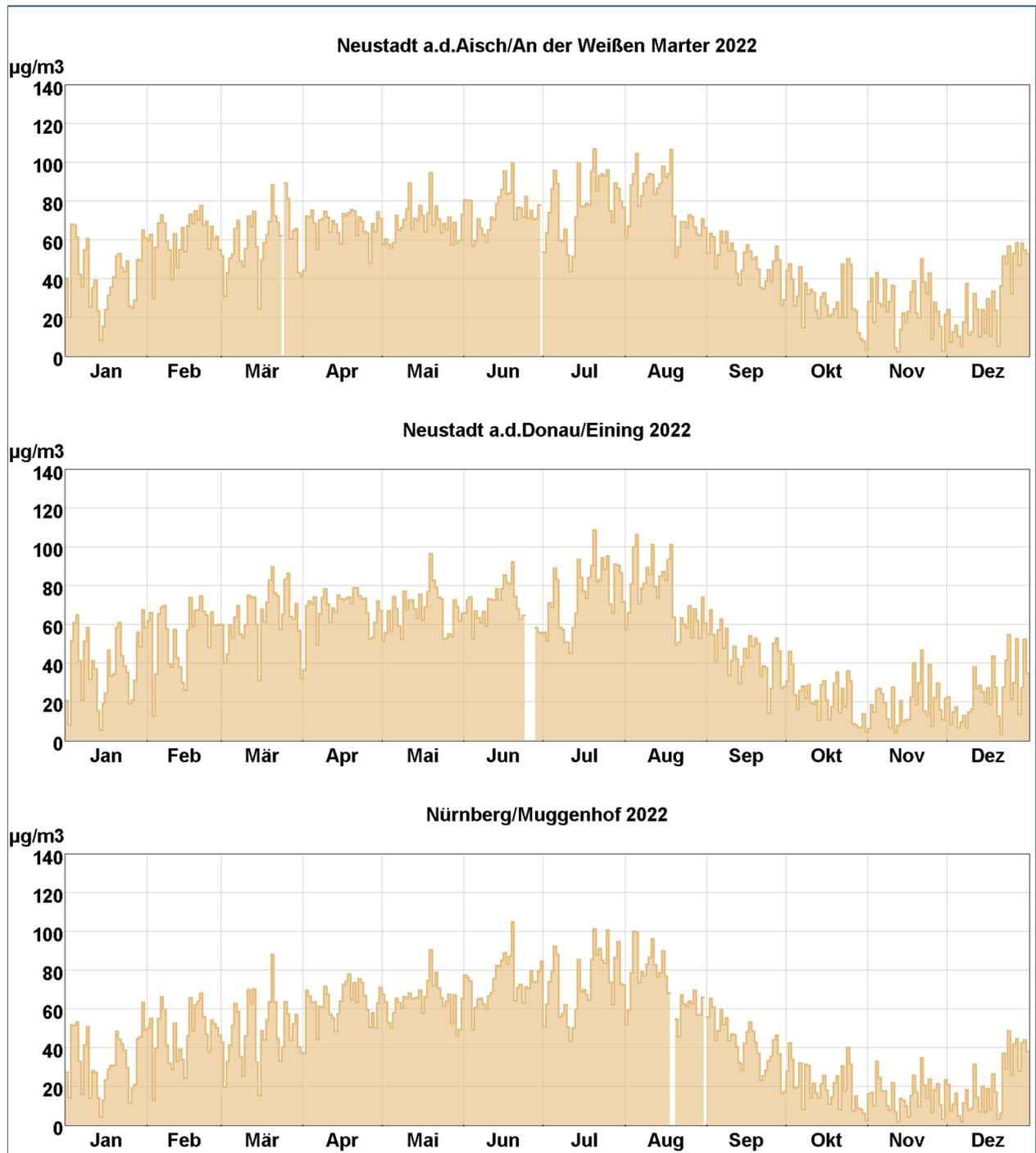
Abb. 9: Tagesmittelwertverläufe von Ozon an den mit Ozonmonitoren ausgestatteten LÜB-Messstationen.
