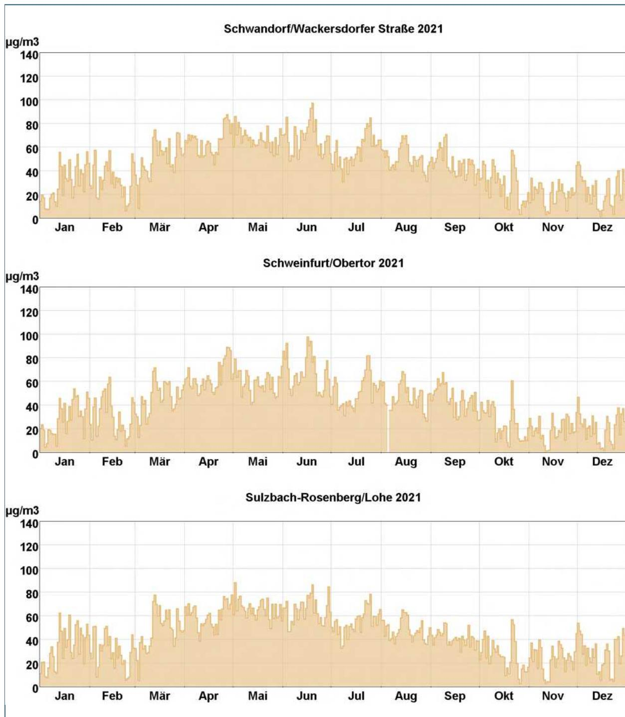
Abb. 11: Tagesmittelwertverläufe von Ozon an den mit Ozonmonitoren ausgestatteten LÜB-Messtationen.
