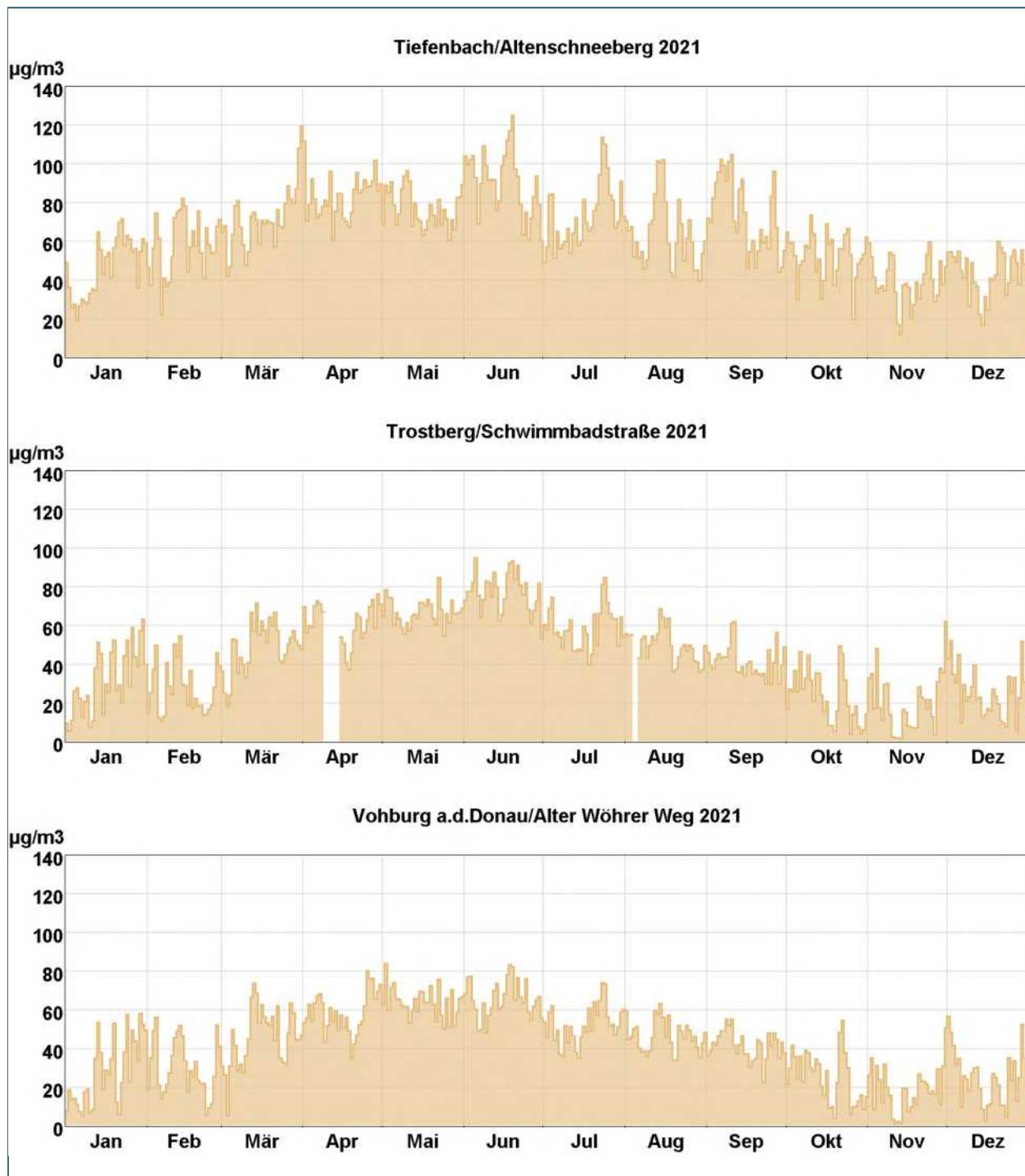
Abb. 12: Tagesmittelwertverläufe von Ozon an den mit Ozonmonitoren ausgestatteten LÜB-Messstationen.
