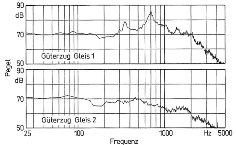
Gemittelte Spektren von Vorbeifahrten von **Güterzügen** auf Betonschwellengleisen mit schlechtem (Gleis 1) und gutem (Gleis 2) Schienenzustand. Es wurden jeweils 55 Spektren von insgesamt 6 Vorbeifahrten gemittelt. Die mittlere Geschwindigkeit auf Gleis 1 betrug 93 km/h und auf Gleis 2 94 km/h. (25 m Gleisabstand)
