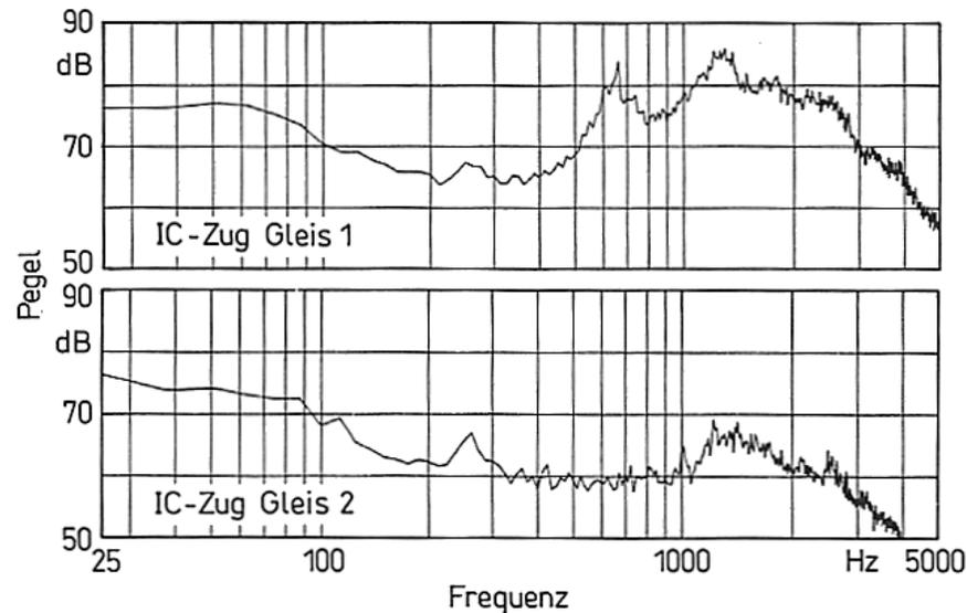
Gemittelte Spektren von Vorbeifahrten von **IC-Zügen** auf Betonschwellengleisen mit schlechtem (Gleis 1) und gutem (Gleis 2) Schienenzustand. Es wurden jeweils 45 Spektren von insgesamt 19 Vorbeifahrten gemittelt. Die mittlere Geschwindigkeit auf Gleis 1 betrug 158 km/h auf Gleis 2 160 km/h. (25 m Gleisabstand)
